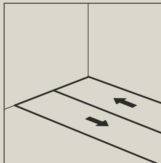
6. Marque o eixo do início da instalação utilizando giz de linha ou com lápis. Faça isso em paralelo com a parede inicial e alinhe a primeira manta com o eixo. Caso o projeto tenha previsão de rodapé do tipo hospitalar, as mantas que estiverem nas extremidades do ambiente devem estar ajustadas com excesso suficiente para subir na parede, permitindo o acabamento posterior. As bordas longitudinais devem estar sobrepostas para serem cortadas posteriormente à colagem.
